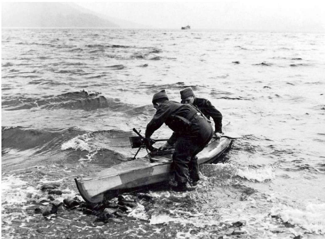
Los kayaks tenían el suelo plano para que se los pudiera arrastrar con mayor facilidad a tierra cuando estaban completamente cargados.
